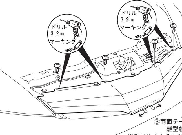
1. 図を参考にして、①フロントグリルカバーを車両に下側から被せるようにセットし、穴位置(4ヶ所)をマーキングして外してください。
