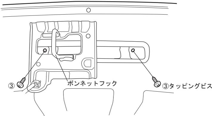
3. 図を参考にして、ボンネット裏側の穴位置から①フロントグリル アッパー裏面の穴位置が合っていることを確認し、③タッピングビスにて仮固定してください。
