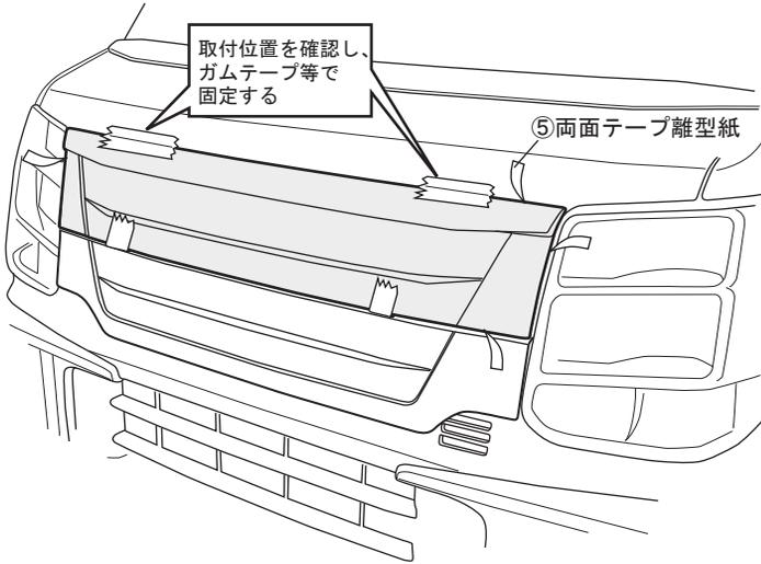
1. 図を参考にして、①フロントグリル アッパー裏面の⑤両面テープの離型紙を5cm程度剥がして折り曲げて表面側にマスキングテープ等で固定してください。
