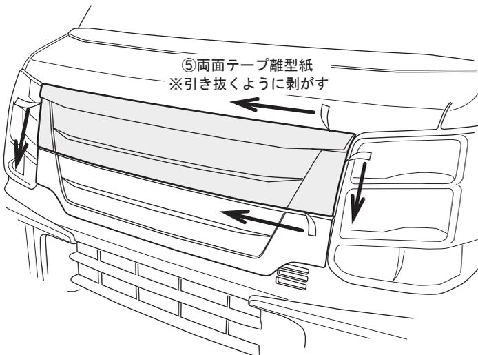
4. 車両ボンネットを閉じて、①フロントグリル ロアの取り付け位置、全体のバランスを確認し、⑤両面テープの離型紙を引き抜くように剥がし全体を十分に圧着してください。
