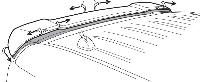
1. 図を参考にして、取付位置を再度確認しながら、①リアウイングを純正ウイングに被せてセットしてください。
