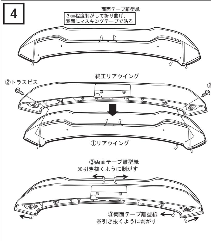
1. 図を参考にして、①リアウイングに貼った③両面テープの離型紙を3cm程度剥がして折り曲げ、①リアウイング表面にマスキングテープ等で貼ってください。
