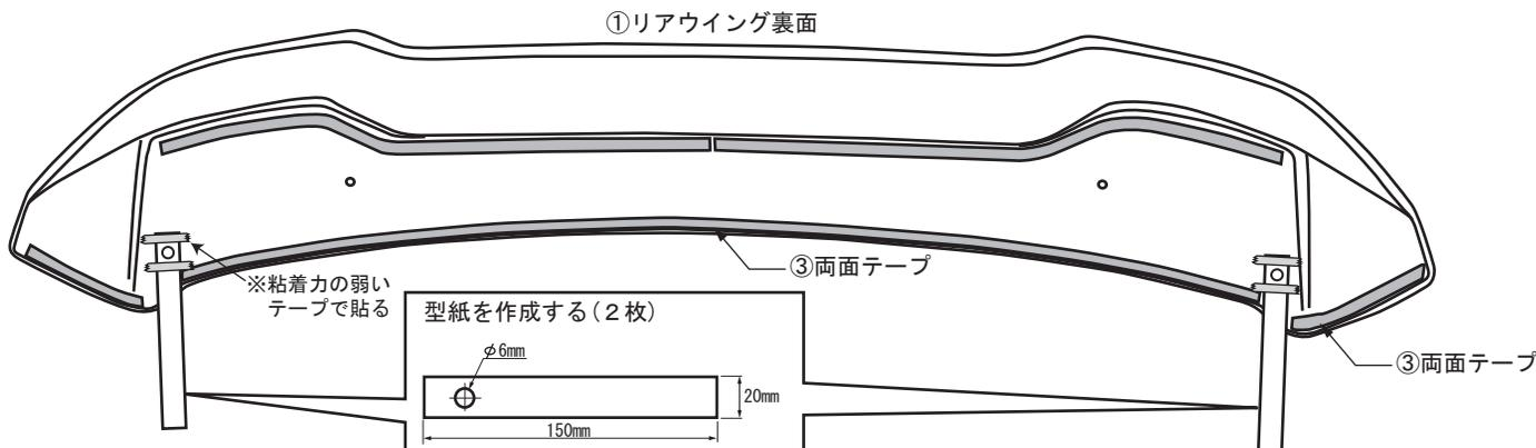
2. 図を参考にして、①リアウイングを車両に取付位置を確認して純正リアウイングに被せるように仮セットしてください。
